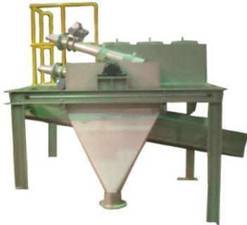
粉塊混合物、粉体などを輸送中のベルトコンベア上からスプーンパイプでインクリメントを定間隔ですくい取り、反転してホッパーシュートに送り込むタイプで、所要のインクリメントが小さい場合でも確実にそのインクリメントサイズで自動的に系統サンプリングを行うことができます。
