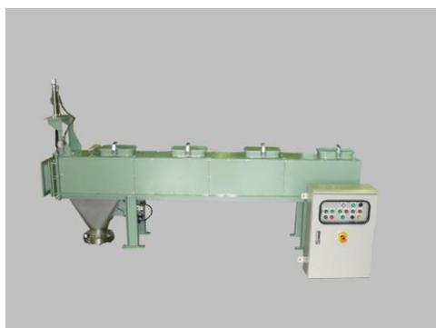
本機は主として 30mm以下の粉、塊、粉塊混合物を輸送するシュート垂直部の途中に設置し、落下中の原料の中にサンプリングボックスが突入、後退して採取、排出を行います。サンプリング部分はメインシュートと同様の大きさで構成され、取り付けが極めて簡単であると共に完全密閉構造となっておりプロセス圧力があってもサンプリングした試料にその圧力の影響を受けない方式です。また本機は1次サンプラーのみならず2次サンプラー、3次サンプラーとして使用できますので試料調製時における縮分用サンプラーとしてご使用頂けます。
